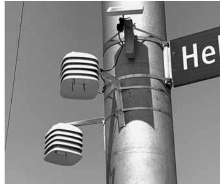
In der Gemeinde Kehrsatz werden in den kommenden Wochen zwei Klimasensoren zur Messung von Hitze und Luftfeuchtigkeit installiert. Ziel ist die Dokumentation von Hitzeinseln, Sensibilisierung der Bevölkerung und Evaluation von lokalen Klimaanpassungsmassnahmen. Die Klimasensoren sind auf eine Zeitdauer von vier Jahren mit einer allfälligen Verlängerung ausgelegt. Die Installation erfolgt an folgenden Standorten:
